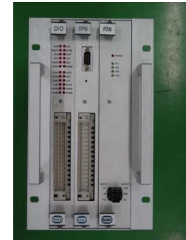
RECTIFIRE CONTROL UNIT
